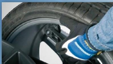
I tecnici devono semplicemente toccare il cerchione con il braccio di misurazione e il sistema inserisce automaticamente le dimensioni del cerchione e seleziona la modalità di equilibratura del peso appropriata.
